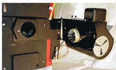
Genom sin sidoupphängning är brännaren mycket enkel att svänga ut för inspektion av munstycke och stoppskiva. (Clean Burn CB-501-I)
